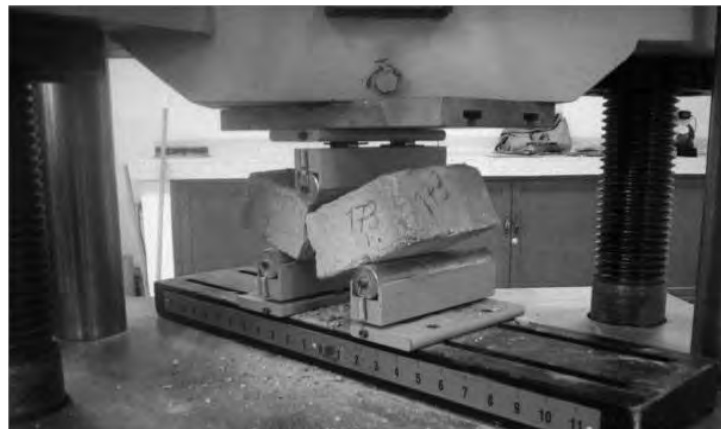
Figura 2. Ensayo de flexión en ladrillos
