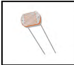
Figura 5. Fotorresistencia empleado como sensor de luminosidad.
