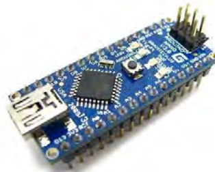
Figura 6. Tarjeta de adquisición de datos (Arduino Nano).
