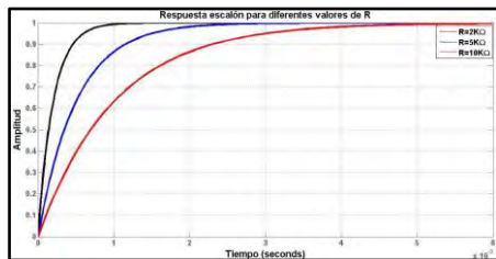
Fig 7. Simulación de la función de transferencia para diferentes valores de R ( R = 2K\Omega, 5K\Omega, 10K\Omega ).
