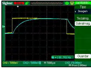
Fig 5. Observación experimental de sistema de primer orden
