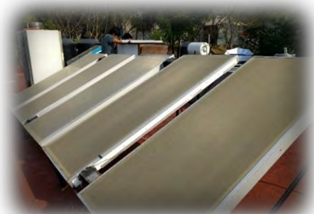
Ilustración 2.-deshidratadora por aire forzado con calentamiento de aire (Elaborado por los autores, 2016).
