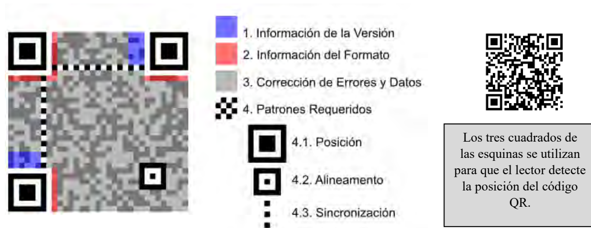
Imagen 3. Estructura de un Código QR, (Wikipedia)
