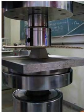
Figura 3. Ensayo de compresión en maquina universal Instron
