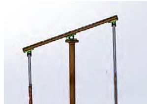
Figura 7.- Movimiento en conjunto de la celda solar con los tornillos de potencia.
