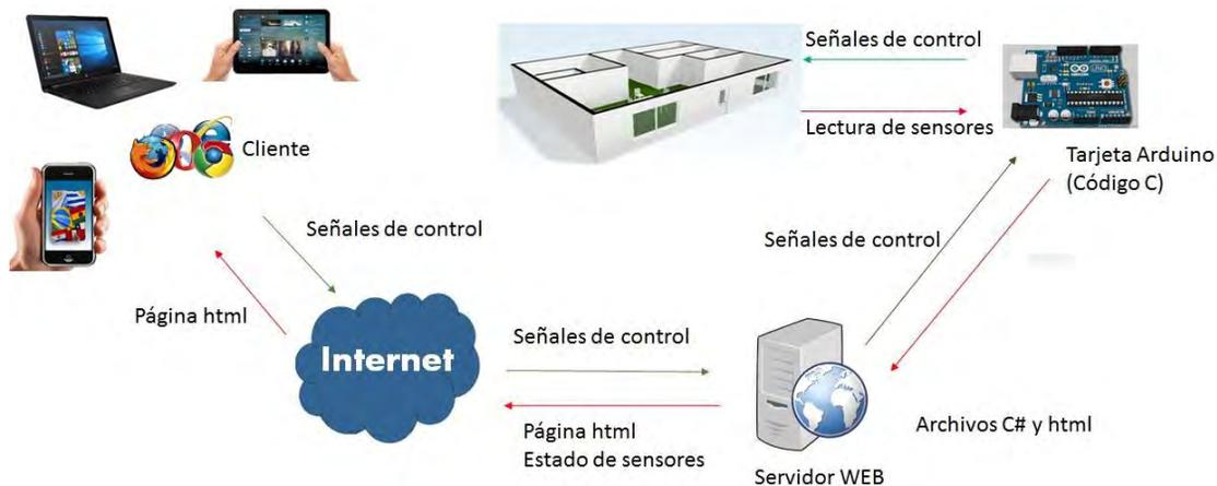
Figura 5. Esquema del sistema de la casa inteligente.
