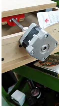
Figura 3. Adaptación de los motores, ejes y usillo.
