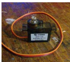
Figura 2, servo motor, se usa para abrir la puerta y ventanas.
