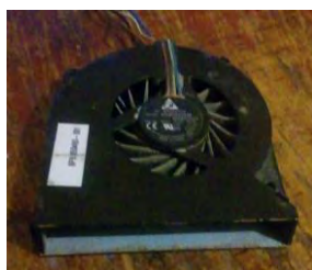
Figura 3, Ventilador para laptop, se usa para el aire de la casa.
