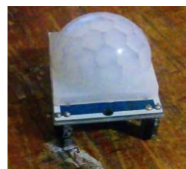
Figura 4, Sensor pir, se usa para los focos y la alarma.
