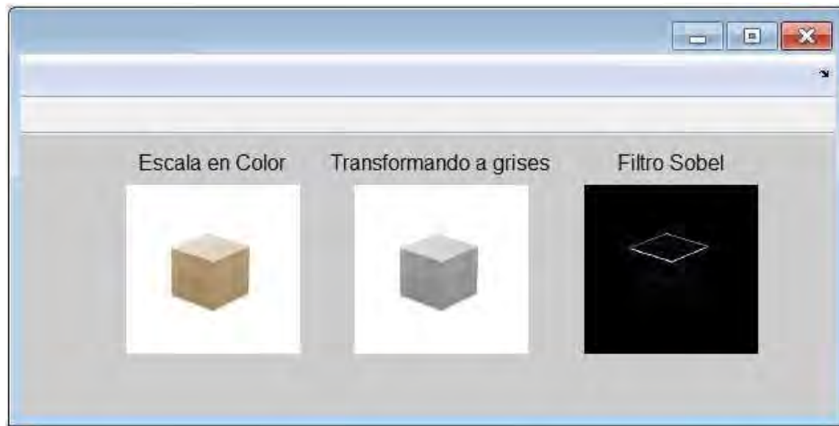
Figura 1. Filtro Sobel aplicado a forma geométrica básica.
