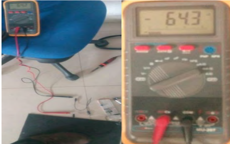
Figura 5. Comprobación de producción de voltaje de los piezoeléctricos.
