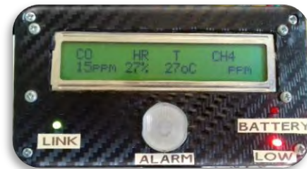
Figura 8. Módulo inalámbrico portátil de recepción de datos.
