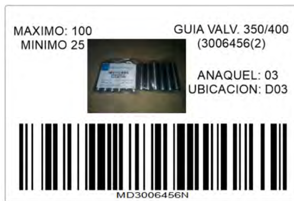
Imagen 1. Tarjeta Kanban con código, Núm. de anaquel, ubicación, nombre de la pieza, con sus máximos y mínimos requeridos de existencia.
