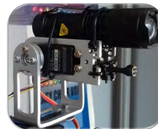
Figura 5. Sistema de iluminación y video IR.
