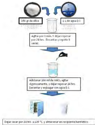
Figura 1. Diagrama de Flujo de Proceso de lixiviación de sales solubles de Sílice residual.
