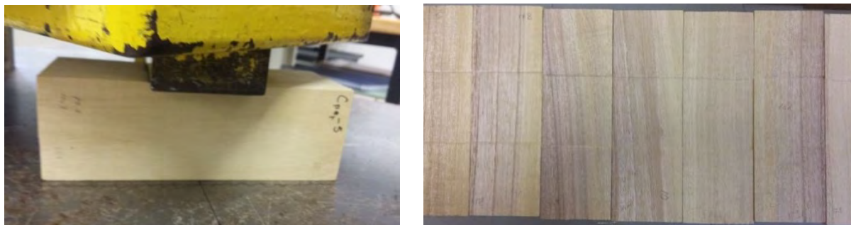
Figura 6 Ensayo de compresión perpendicular a la fibra y Probetas ensayadas
