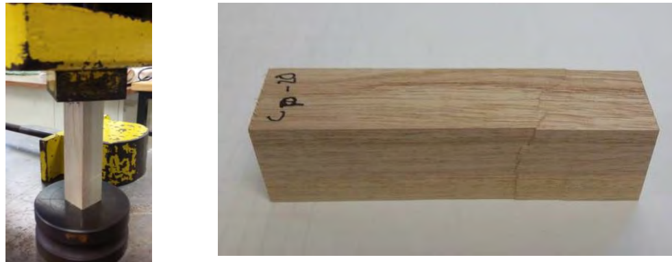
Figura 4. Ensayo de compresión paralela a la fibra y falla en la probeta ensayada
