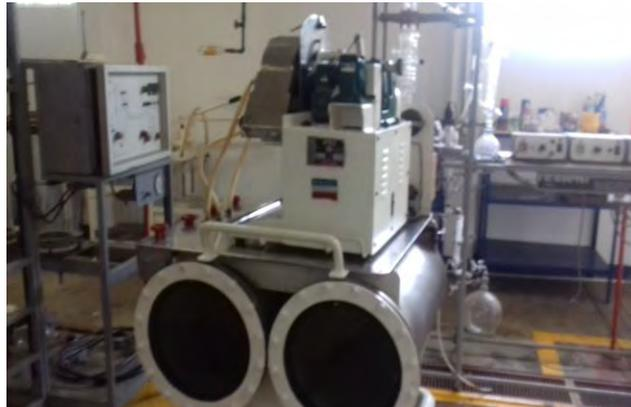
Figura 3. Filtro rotatorio al vacío.
