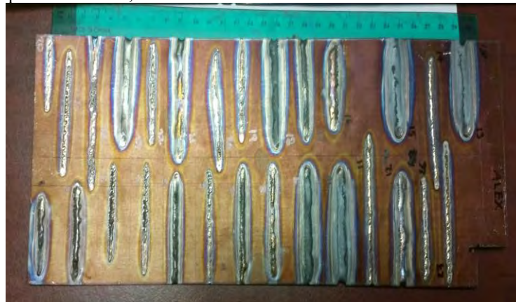
Figura 3. Cordones de soldadura con el equipo PTA.
