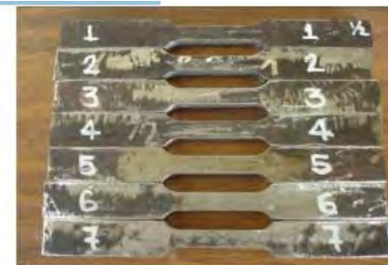
Figural.Muestra de sección rectangular longitudinal para el ensayo de tensión– deformación
