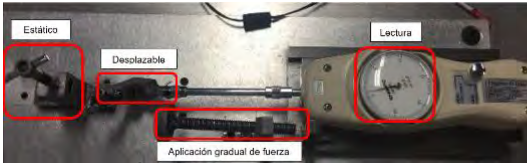
Figura 7. Probador de tensión.
