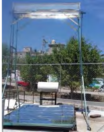
Figura 1: Concentrador Solar Lineal tipo Fresnel (CSLF).
