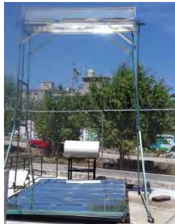
Figura 7.- Concentrador CPC con lámina de aluminio terminado en espejo, para distribuir la radiación solar reflejada por el primer concentrador horizontal de espejos.
