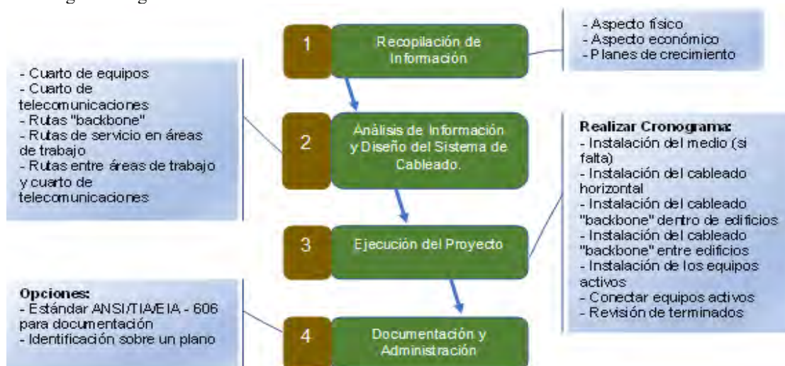
Figura 2 Metodología de instalación de redes de comunicación. Fuente (Diseño Propio).
