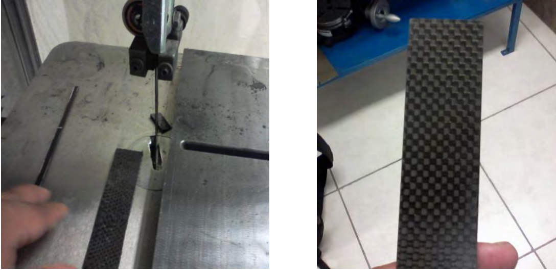
Figura 1. Corte de probeta con cinta de diamante para tensión uniaxial
