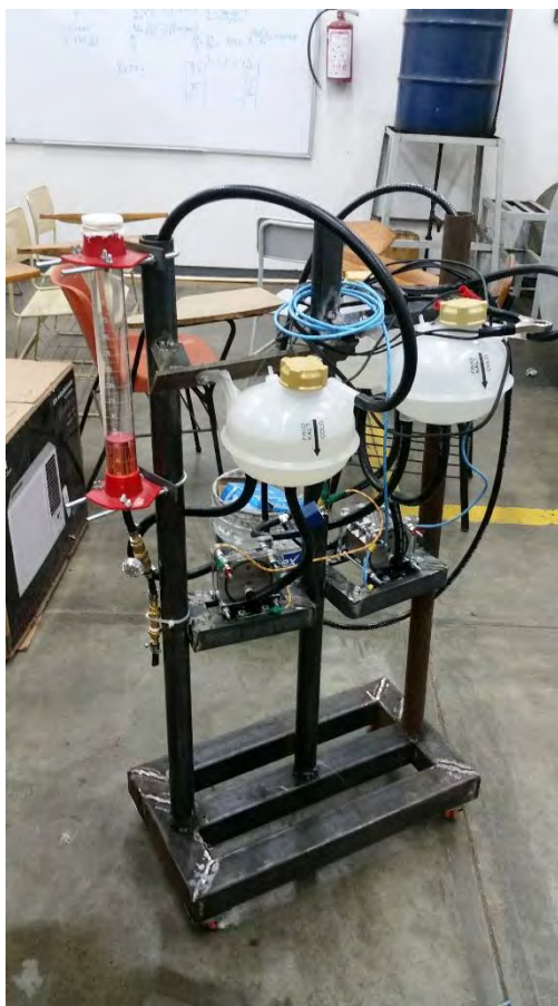
Figura 3. Sistema de generación de hidrógeno.
