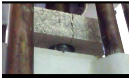
Fig. 3. Pruebas de compresión a Blocks de tepezil
