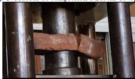
Fig. 4. Pruebas de compresión ladrillo rojo de arcilla
