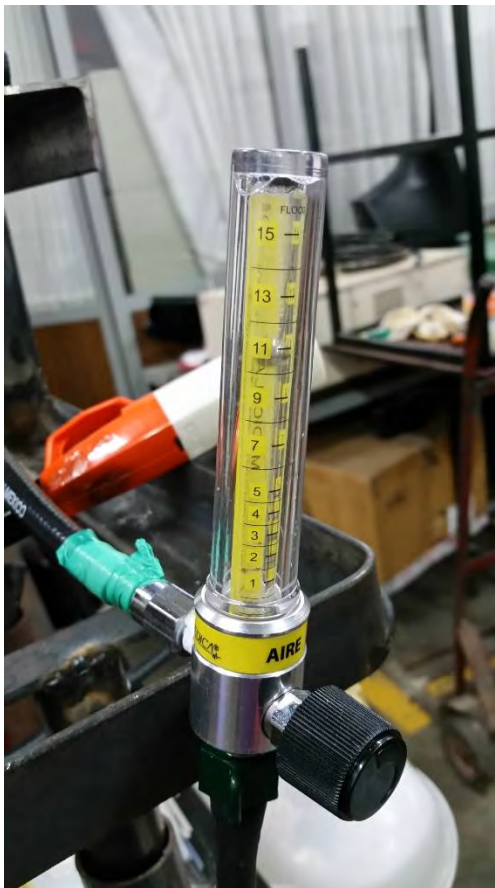
Figura 4. Medición del flujo de HHO generado
