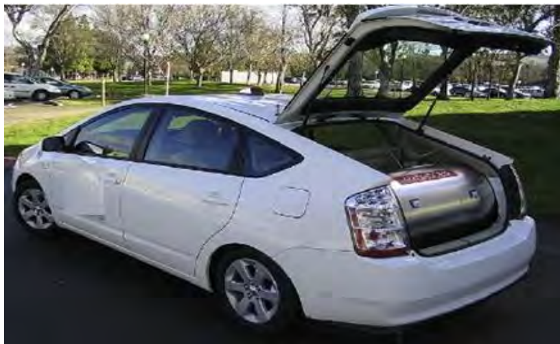
Figura 2. Recipiente de presión criogénico de hidrógeno montado en un automóvil para pruebas experimentales de manejo.
