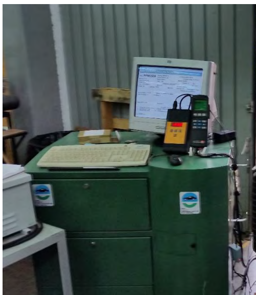
Figura 2. Sistema de medición de emisiones
