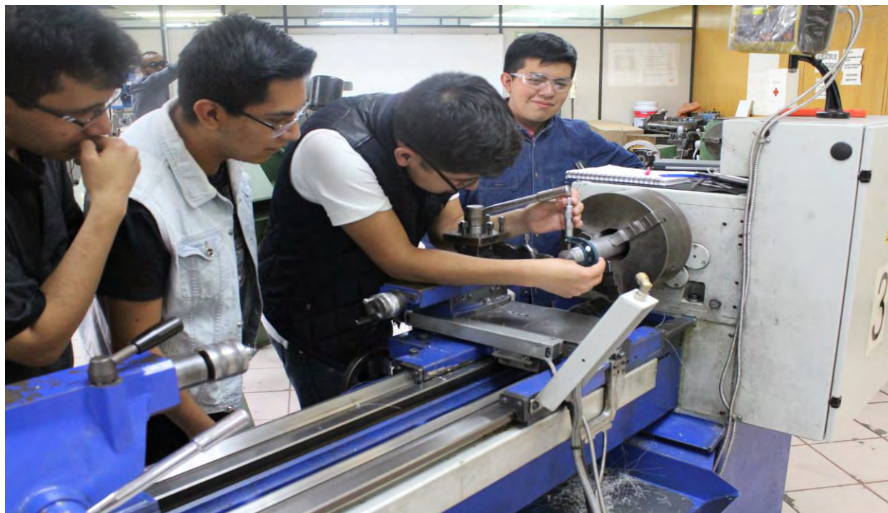
Figura 2. Alumnos realizando una medición de precisión utilizando un micrómetro analógico.
