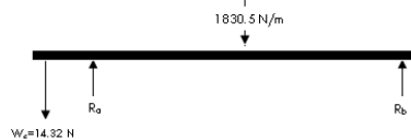
Figura 5.- Diagrama del cuerpo libre de transportador sin fin
