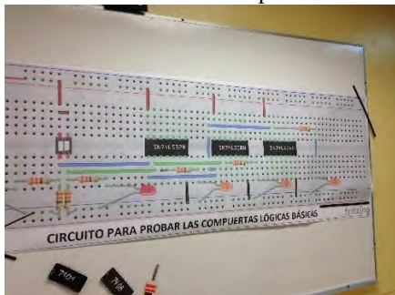
Figura 2. Impresión en papel resultado de una simulación junto con material didáctico de circuitos integrados
