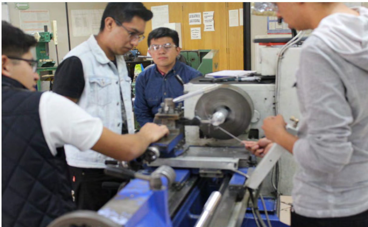
Figura 1. Alumnos realizando un maquinado diametral inicial a una pieza.
