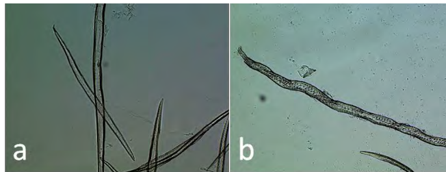
Figura 2. Microscopía óptica a 10X. a) Fibra sin blanquear. b) Fibra blanqueada.
