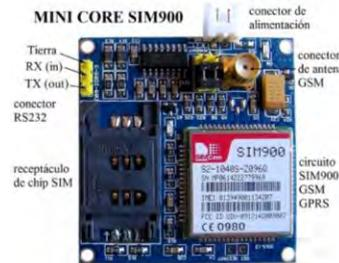
Figura 9 Módulo GPRS/GSM basado en el SIM900.
