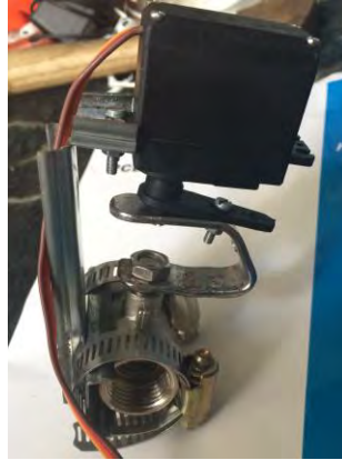
Figura 1. Válvula acoplada a servomotor.
