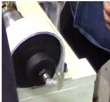
Figura 11. Material Extruido en perfil de poliamida 6 virgen.
