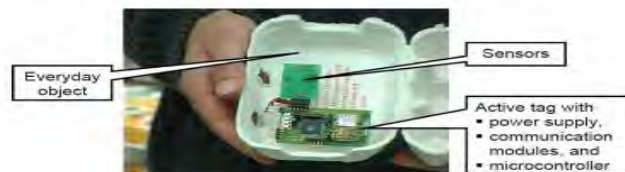
Figura 2.- Un objeto inteligente: un elemento cotidiano aumentado con un sensor y una placa de control (Siegemund F., 2004).
