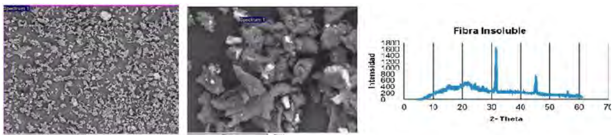
Figura 6. Análisis mediante Microscopia electrónica de barrido, (SEM) y DR-X de la fibra insoluble obtenida a partir de la cáscara de naranja.
