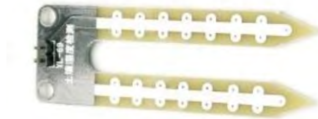
Figura 3. Sensor de humedad geofísico YL-69.
