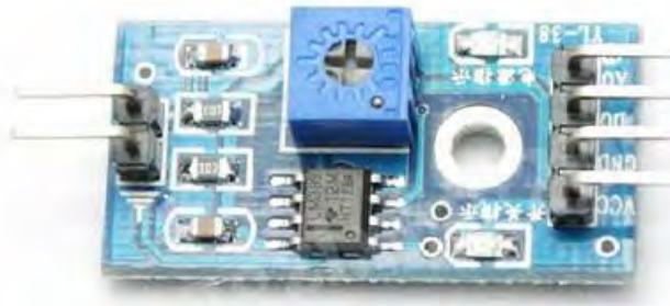
Figura 4. Tarjeta PCB del sensor de humedad.
