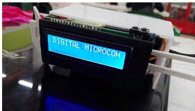
Figura 10. Vernier digital inalámbrico terminado.
