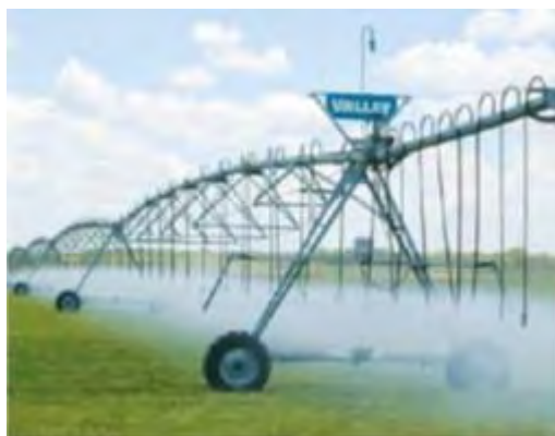
Figura 2. Sistema de avance frontal.
