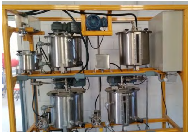
Figura 3. Reactor semi-automático De Lorenzo, para la elaboración de biodiesel.
