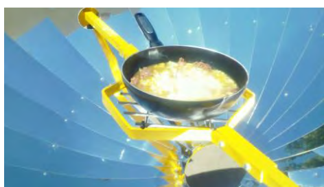
Fig.4 Concentrador Solar en operación, prueba de cocción. Fig. 5 Temperatura máxima alcanzada de 345 °C en la prueba de calentamiento de una sartén de hierro fundido de 3.5 Kg de peso color negro.
