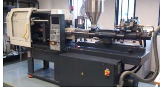
Figura 3. Equipo de moldeo por inyección utilizado.
