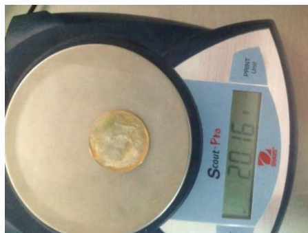
Figura 2: Pesado de piezas en bascula Scout Pro de Hoaus.
