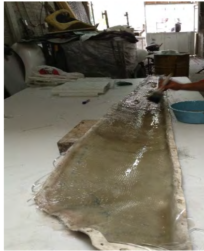
Figura 4. Picado de la fibra sobre el molde.
