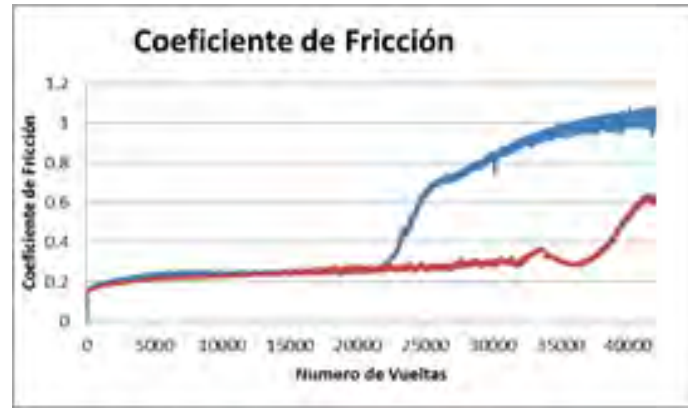
Figura 5. Análisis de desgaste y coeficiente de fricción para los aceros D3 tratados mediante PVD.
