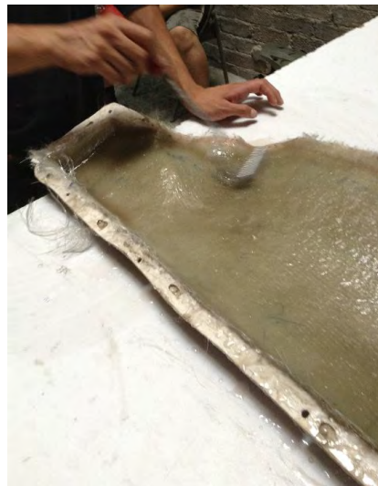
Figura 5. Rodillado de la fibra.
