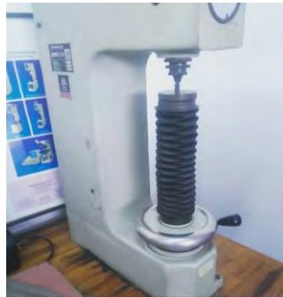
Fig. 1. Ensayo de dureza Rockwell.
