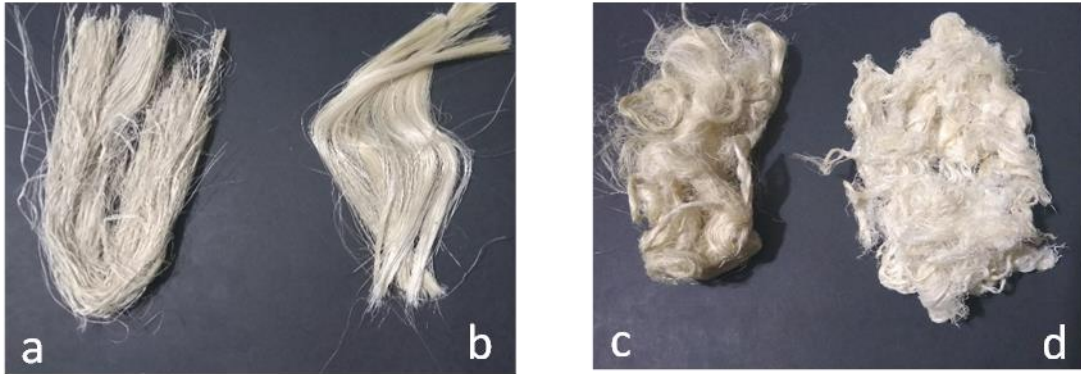
Figura 4. Obtención de celulosa por los procedimientos de pulpeo: fibras sin tratar (a), fibras seca para iniciar tratamiento de pulpeo (b), celulosa obtenida por el primer (c) y segundo (d) procedimiento. Fuente: Autores
