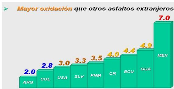
Figura 2. Comparación del Índice de Durabilidad de diferentes muestras de asfalto AC-20 de diversos países.
