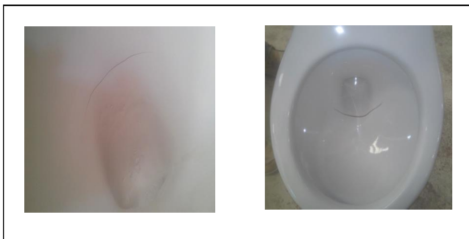
Figura 2 Grieta en una pieza cruda y en pieza cocida. Fuente: Elaboración propia.
