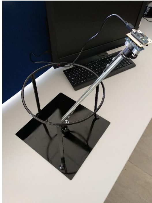
Ilustración 7 Vista Lateral de la Base de pruebas para el Control de Vuelo con Sensores
