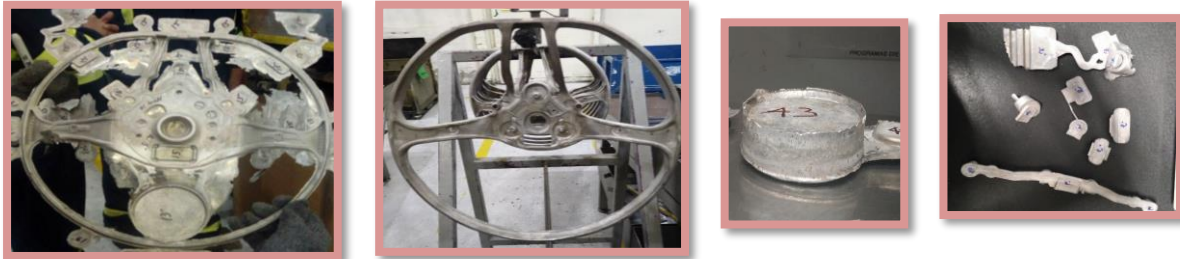
Figura 6. Armadura sin troquelar, troquelada, pastilla y sobrantes
