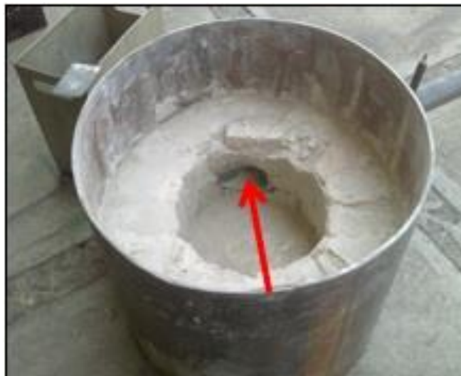
Figura 3. Entrada de aire
