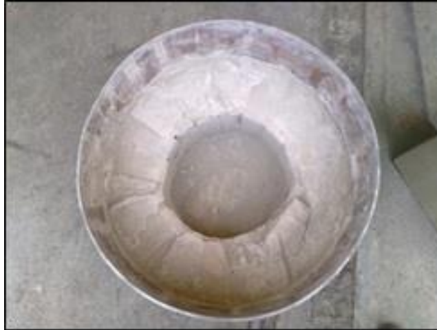
Figura 2. Fraguado del refractario
