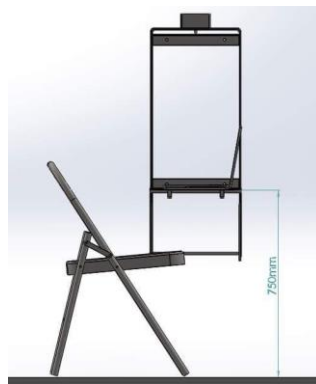
Figura 1. Dimensiones del piso a la base.
