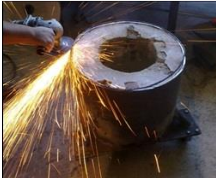
Figura 6. Muestra el corte 0.5 cm para la modificación.
