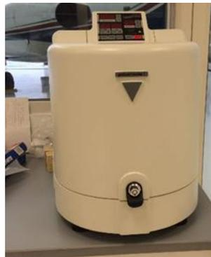
**Figura 2** Molino planetario
