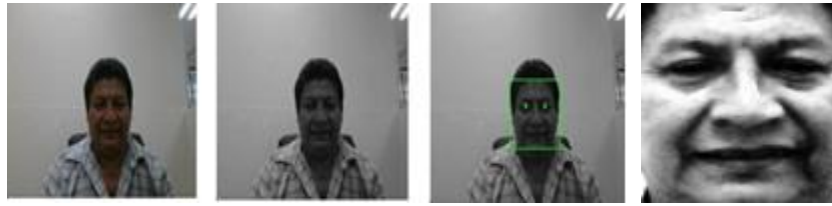
Figura 3. Imagen original y detección del rostro aplicando los filtros de correlación sintética.
