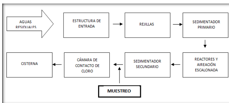
Figura 1. Proceso simplificado de tratamiento de aguas residual en la planta de TES Jilotepec. Fuente: Propia.
