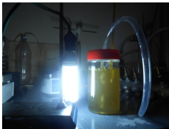
Figura 2. Prototipo de Biorreactor escala laboratorio con luz artificial. Fuente: Propia.
