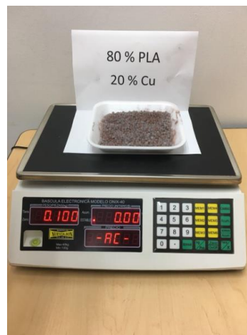
Figura 1 Mezcla de PLA con polvo metálico de Cobre (80% PLA y 20 % Cu). Fuente: TecNM / ITN.
