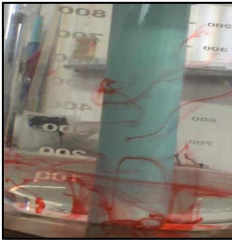
Figura 1 - Tubo concéntrico de 0.78 in, en un fluido Newtoniano a 12 rpm
