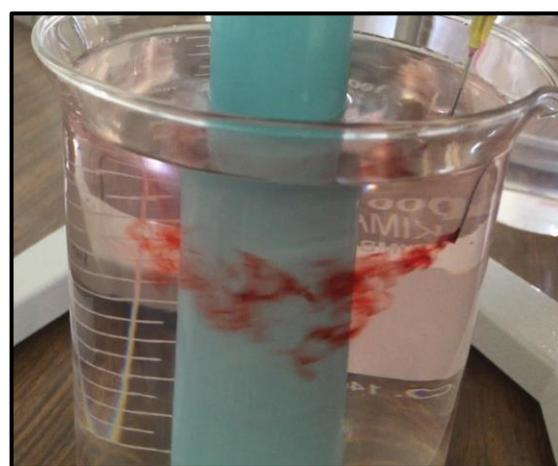
Figura 4 - Tubo concéntrico de 1.2 in, en un fluido Newtoniano a 350 rpm
