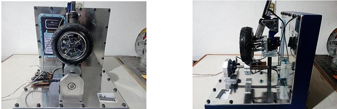
Figura 8. Prototipo físico del sistema de suspensión independiente.
