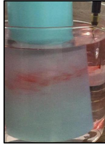
**Figura 6 - Tubo concéntrico de 1.06 in, en un fluido Newtoniano a 350 rpm**
