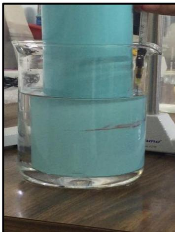
**Figura 7 - Tubo concéntrico de 1.9 in, en un fluido Newtoniano a 12 rpm**
