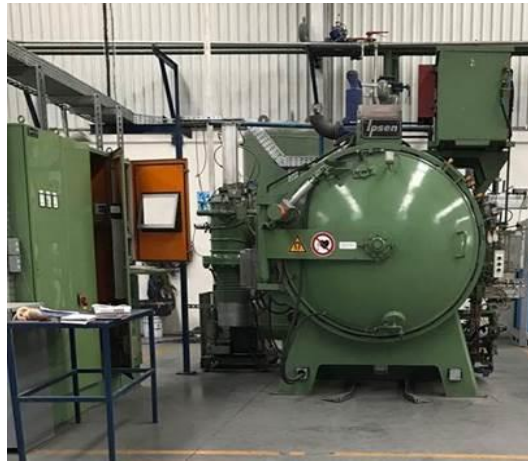
Figura 2. Horno al vacío empleado para el tratamiento térmico de los aceros grado herramienta.
