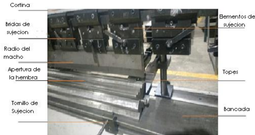
Figura 1: Se observa como los dados están montados ajustados y listos en la máquina.
