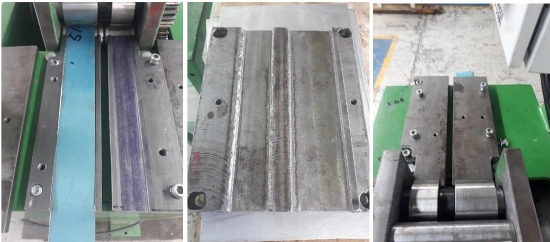
Figura 11 Placas guía corregidas y placa guía original.
