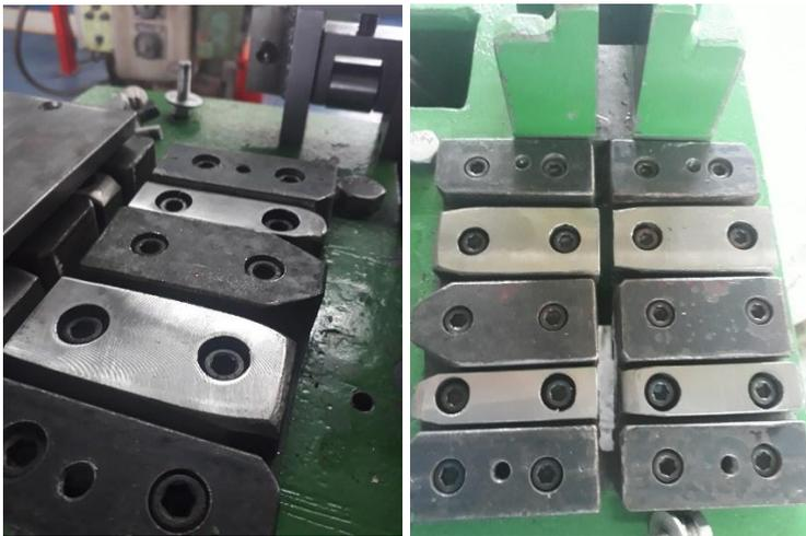
Figura 10 Corrección de alturas de las guías finales.
