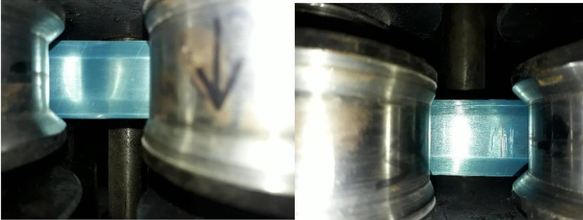
Figura 6 Desalineación de rodillos.
