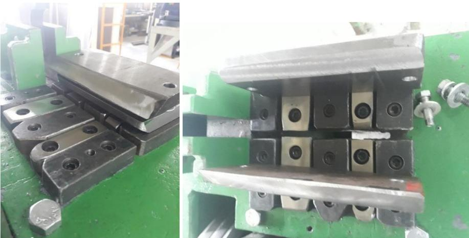
Figura 14 Placas superiores con ángulo para evitar que se atore el perfil.
