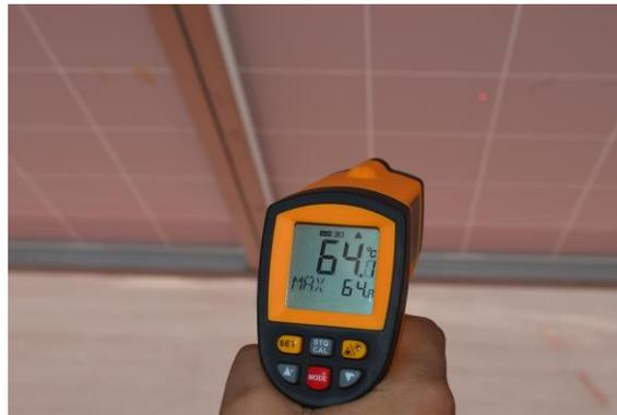
Figura 1. Medidor de temperatura de superficie.
