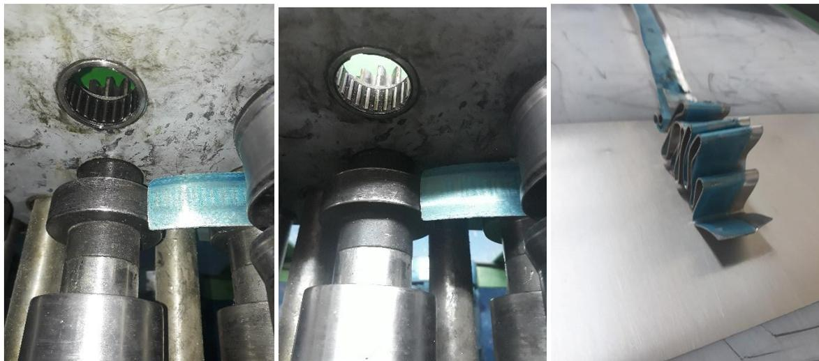
Figura 5 Estación No.2 perfil con curvatura.
