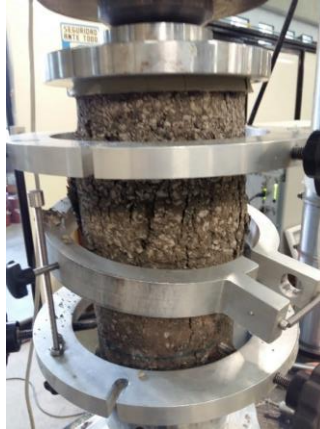
Figura 3. Prueba de resistencia a compresión
