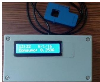
Figura 4. Módulo de control energético, con el sensor de corriente no invasivo modelo SCT-013-000, este se coloca en cada una de las líneas de alimentación, de aires acondicionados, líneas de contactos y luces.
