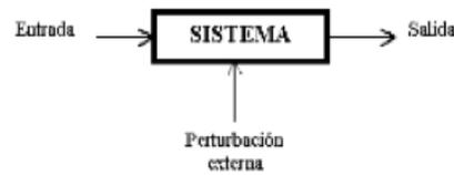
Figura 5. Conformación de un sistema
