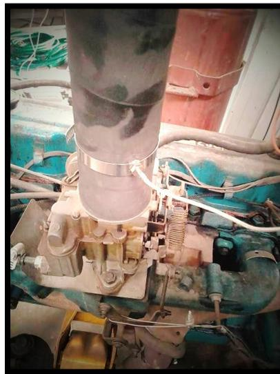
Figura 2. Termopar en la admisión.
