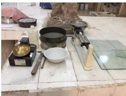
Figura 2. Herramientas necesarias para determinar el Límite Líquido
