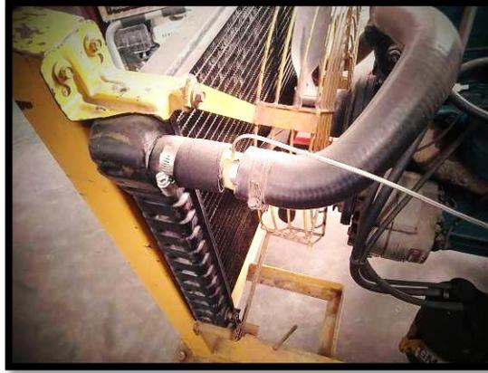
Figura 3. Termopar en el radiador.
