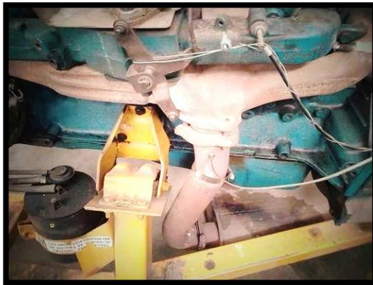
Figura 4. Termopar en el escape.
