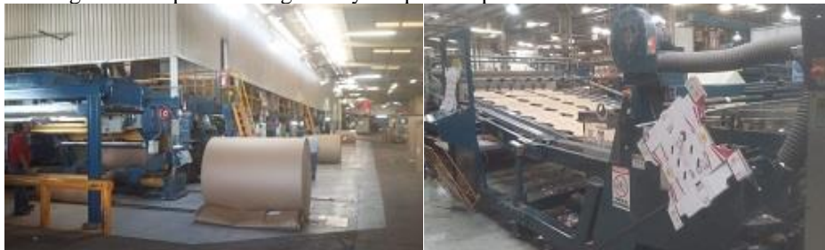
Figura 1. Proceso de máquina Corrugadora e impresora
