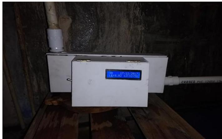
**Figura 2. Prototipo de medidor digital hídrico en operación.**
