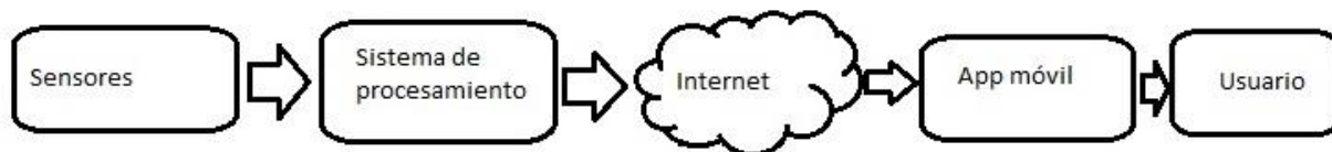
Figura 2. Diagrama a bloques del sistema de monitoreo remoto
