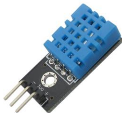
Figura 3. Sensor de temperatura y humedad DHT11
