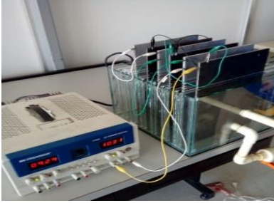
Ilustración 2 Colocación de las placas de aluminio y acero Fuente: Elaboración propia
