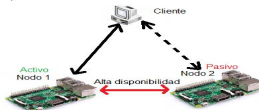
Figura 4- Configuración Activo-Pasivo de Clúster de AD
