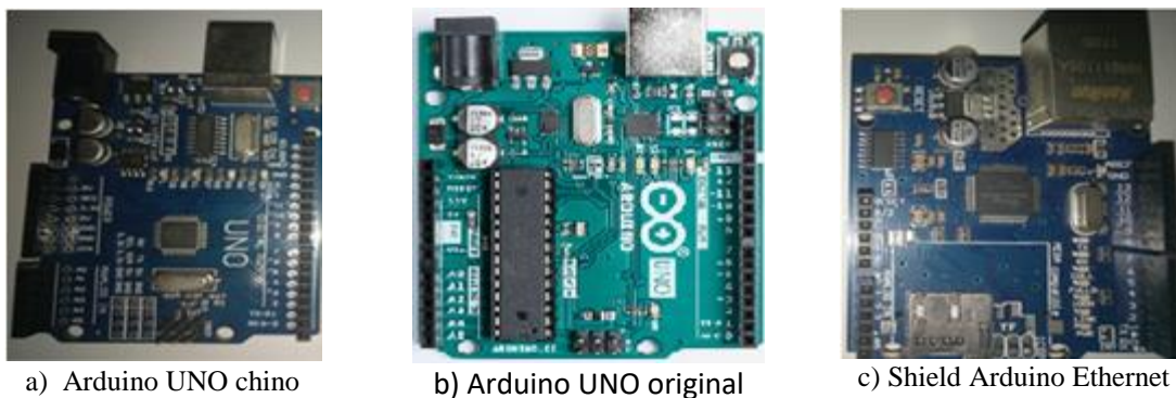
Figura 3.- Diferentes marcas de Arduinos y Shield Arduino Ethernet
