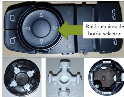
Figura 2. Producto final terminado y componentes móviles.
