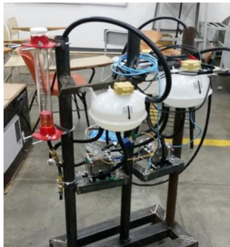
Figura 4. Sistema de generación de hidrógeno
