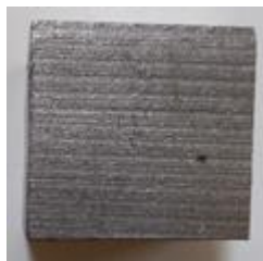
Imagen 1.2 Acero 8620 con tratamiento shot-peening.
