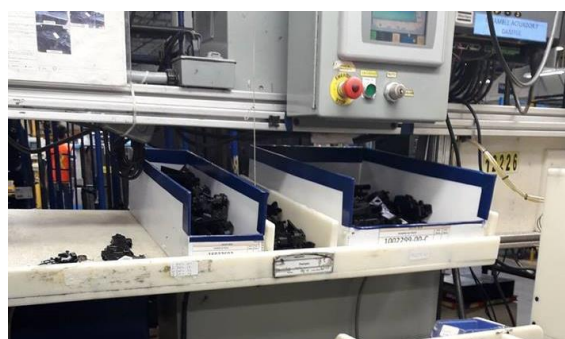
Figura 3. Proceso de mejora de la estación añadiendo contenedores de material.
