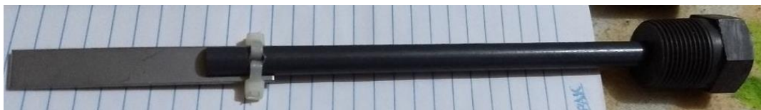
Figura 5. Testigo de corrosión de acero al carbón instalado en porta testigos
