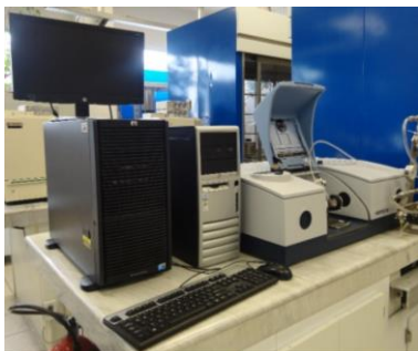
Figura 3. a) espectrofotómetro FT-IR Vertex 70v (Bruker, EUA); b) accesorio universal ATR MIRacle (PIKE Technologies, EUA) para análisis de sólidos y líquidos.
