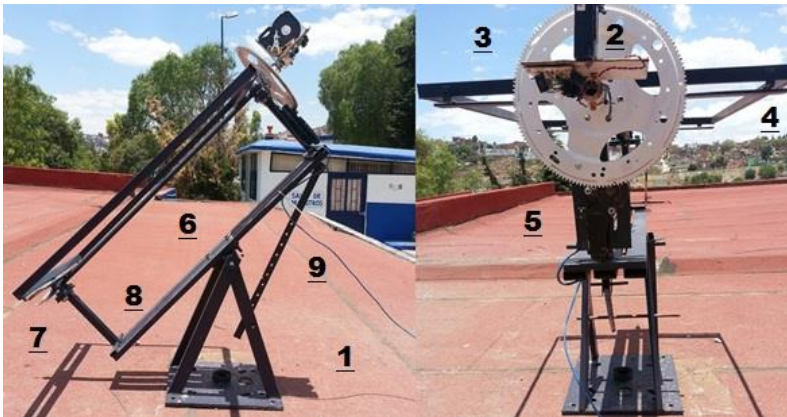
Figura 8. Partes de la estructura del seguidor solar
