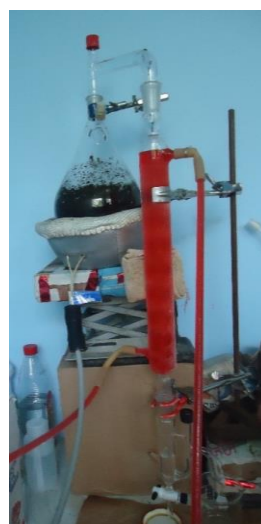
Figura 2. Equipo para extracción de AE por HD
