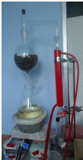
Figura 1. Equipo para extracción de AE por DAV
