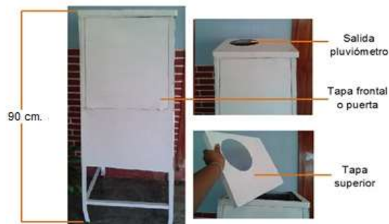
Figura 1. Estructura de resguardo del instrumento y de los sensores.
