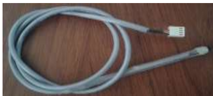
Figura 3. DS18B20 con aislante para líquidos.
