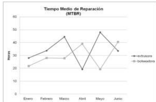
Figura. 4 Gráfica del MTBR línea uno, primer semestre 2014. Fuente: Reportes de producción y mantenimiento
