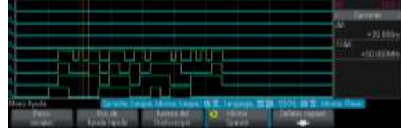
Figura 13. Resultados de implementación en FPGA, codificador de tasa 1/2 diseñado en StateCAD.
