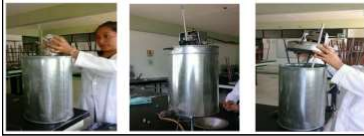
Figura 14. Vaciado del PET en el reactor químico para la fundición (Fuente: ITSSAT).
