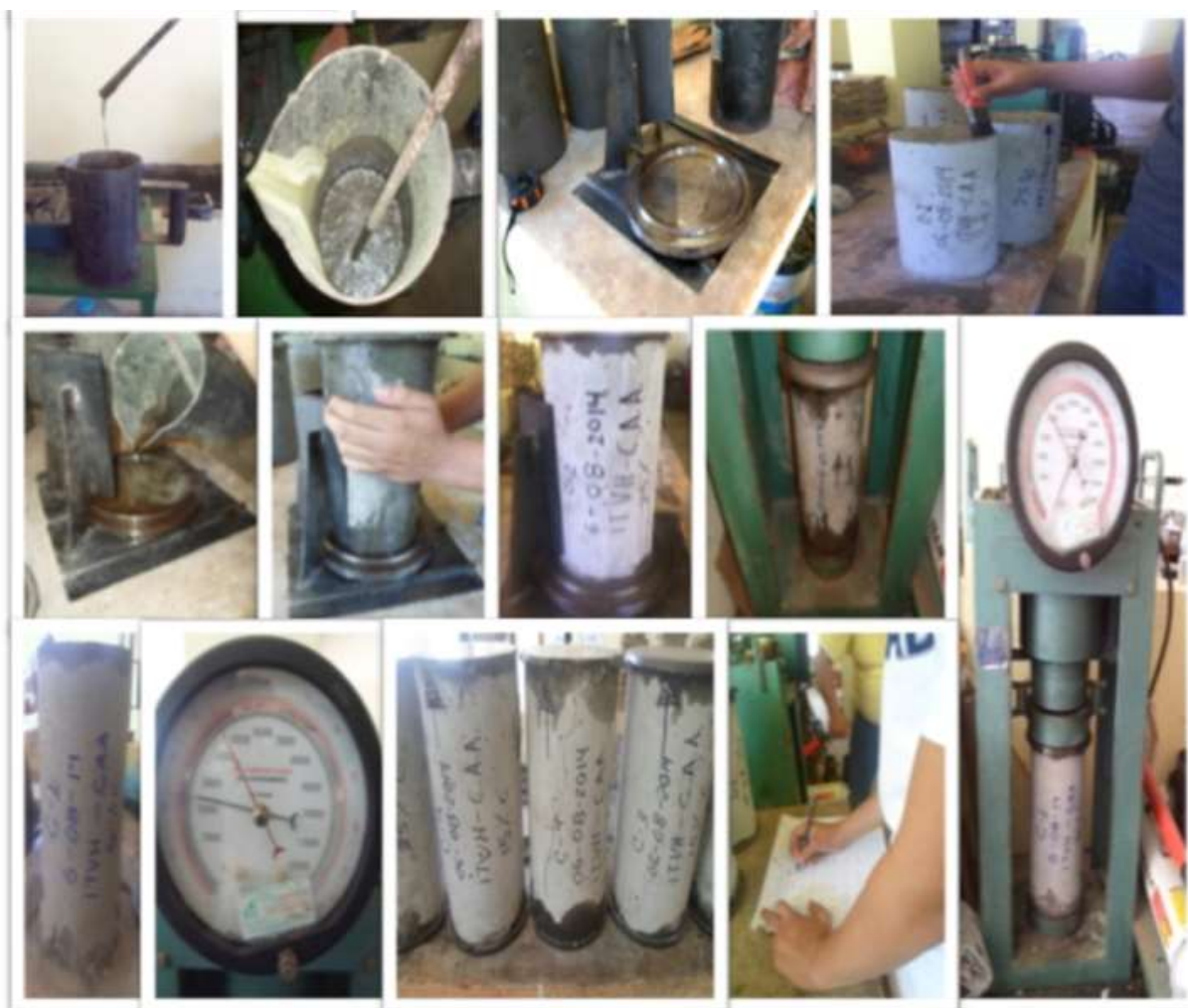
Figura 3. Cabeceado y prueba de resistencia a los cilindros en cada una de sus fases
