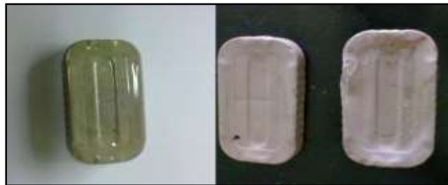
Figura 15. Placas de PET obtenidas del proceso de reciclaje (Elaboracion propia).
