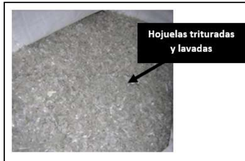
Figura 12. Hojuelas de PET trituradas, lavadas y secadas (Fuente: ITSSAT)
