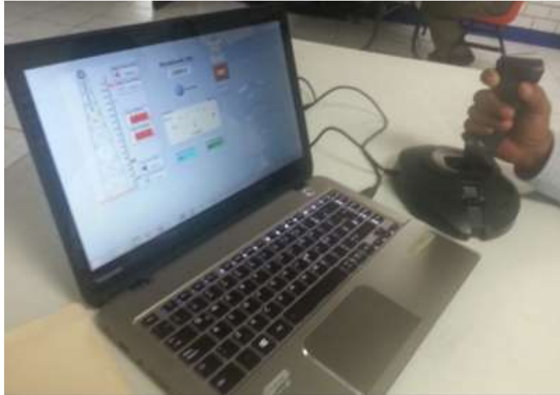
Figura 5a. Block detenido en un límite superior a pesar de que el usuario mantiene accionado el joystick ordenando subir el block.
