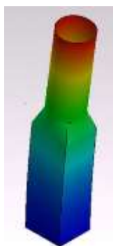
Fig. 9. Segunda forma modala flexión 5.58Hz
