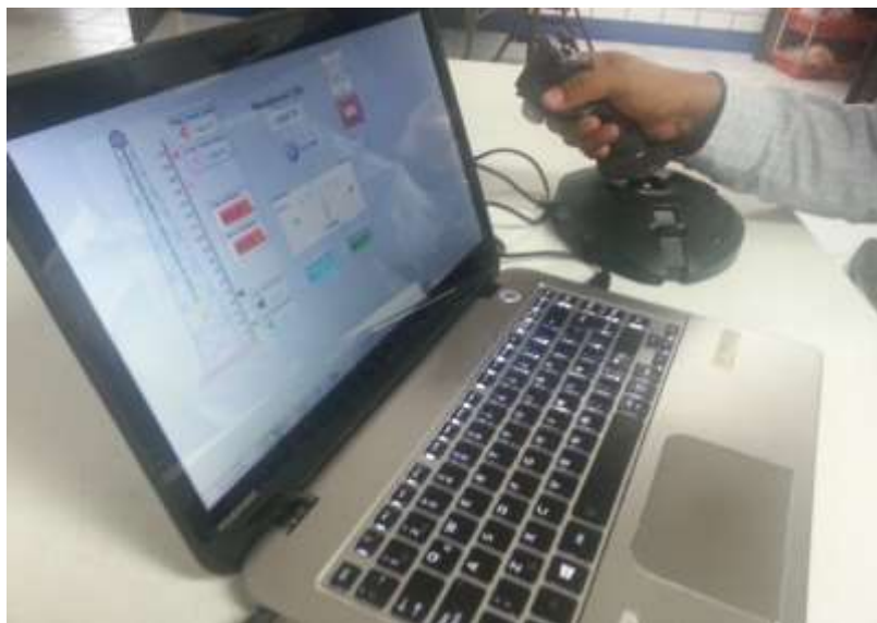
Figura 5b. Block detenido en un límite inferior a pesar de que el usuario mantiene accionado el joystick ordenando bajar el block.
