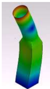
Fig. 10. Tercer forma modala flexión 20.84Hz
