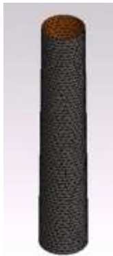
Fig. 3. Chimenea cono truncado Malla 3422 Elementos
