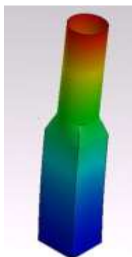
Fig. 8. Primer forma modala flexión 5.13Hz
