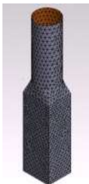
Fig. 7. Chimenea de CFE Malla 3149 Elementos.
