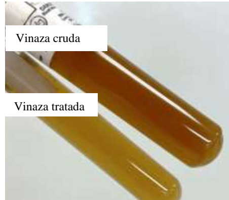
Figura II. Proceso de fotólisis UV/H 2 O 2 en vinaza cruda
